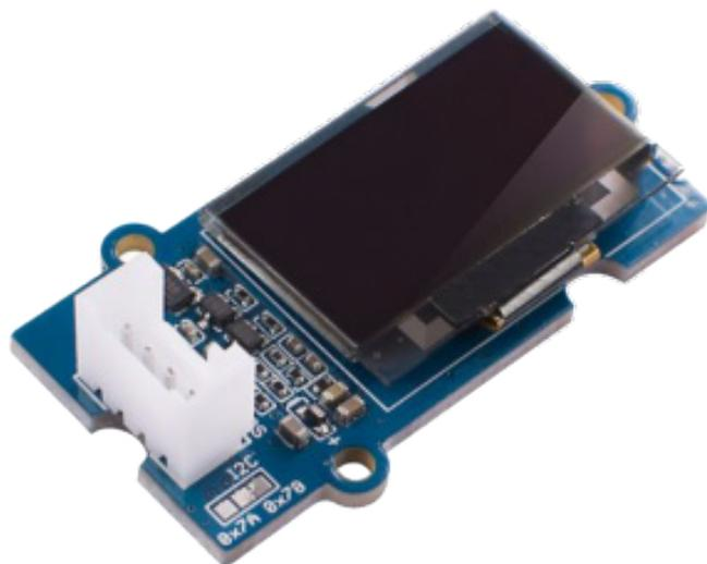
Cuando permitimos que la corriente fluya en el circuito, los electrones cruzan la frontera entre estos dos materiales y liberamos energía excedente, emitiendo un rápido destello de luz. Todos esos destellos producen un brillo sordo y continuo. Un OLED simple se compone de seis capas diferentes.
