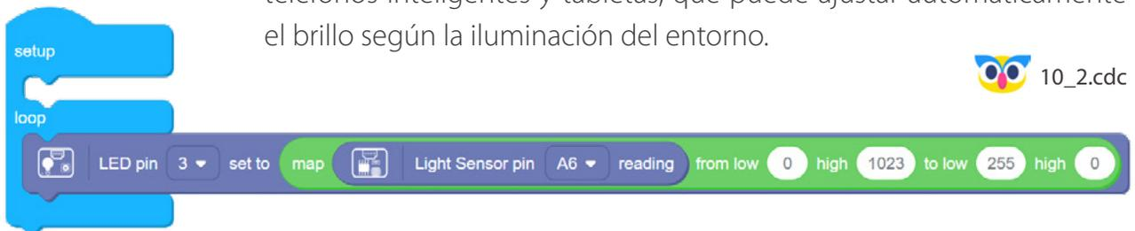
Aquí, las palabras bajo-alto significan extremos bajo y alto del rango y, en este caso, aunque pueda parecer extraño, el extremo bajo del rango es más alto que el extremo alto del rango para volver a mapear, porque queremos que el LED se vuelva más brillante cuanto menos luz a su alrededor. Recuerde que para que el LED cambie el brillo, debe conectarlo con el cable Grove al pin 3; esto es debido a que el pin 4, al que está conectado el módulo LED de forma predeterminada, no admite la salida PWM.
