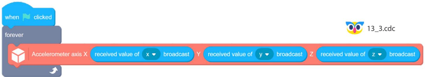
Conéctese a Arduino en el modo Dispositivo como lo hace normalmente cuando usa un monitor en serie o la consola del serial. Luego vaya al modo de escenario, presione el botón de la bandera y haga clic en el botón **Abrir ventana del acelerómetro de 3 ejes** en la categoría de visualización del acelerómetro de 3 ejes. Los datos fluyen desde el sensor a la placa base del kit Grove Zero Beginner y luego a la computadora, donde se visualizan en la ventana del navegador. Genial, ¿no?
