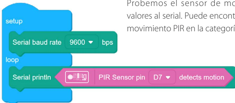
Probemos el sensor de movimiento enviando sus valores al serial. Puede encontrar el bloque de sensor de movimiento PIR en la categoría de Grove Digital.
