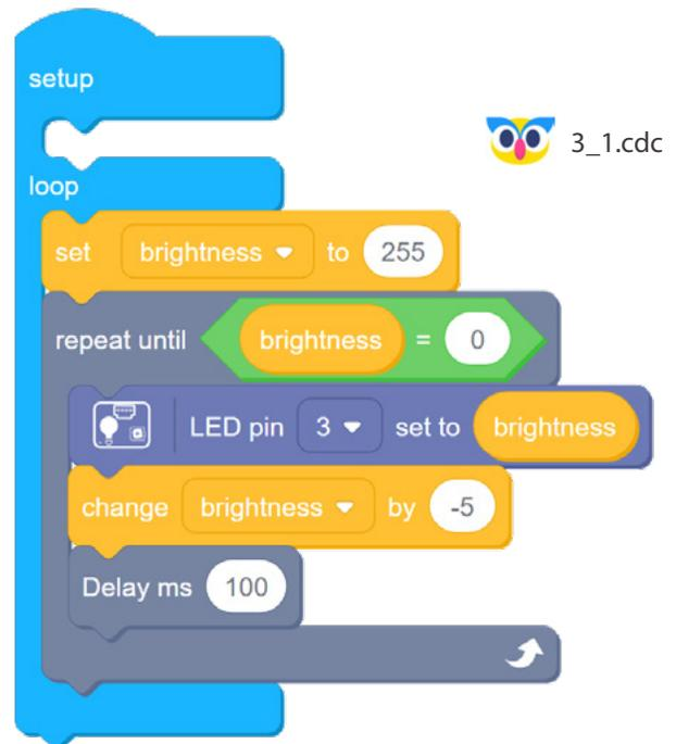
Recuerde, el módulo LED todavía necesita estar conectado al Pin 3 con el cable Grove, ya que el Pin 3 puede usar PWM y el Pin 4 no.
